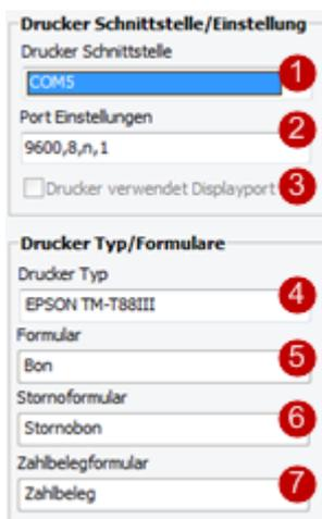
Ist Bondrucker verwenden auf Aktiv gestellt, so wählen Sie über die Auswahl der Drucker Schnittstelle **1** die Schnittstelle, an die Ihr Bondrucker angeschlossen ist. Die Ports werden aus dem PC ausgelesen. Es kann allerdings vorkommen, dass man die Ports manuell vorgeben muss, da der benötigte Port nicht aufgelistet wird. Unter dem Bereich **Portvorgabe** ist das Vorgehen näher beschrieben.
